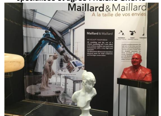
Le robot réalise l'ébauche, et le sculpteur se concentre sur les finitions et donne l'âme à la sculpture. (source : site Maillard – Granits)
