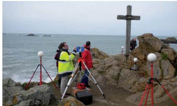
Le réglage du matériel utilisé pour scanner en 3D la Pointe du Christ (on voit le gisant, sur la droite).
